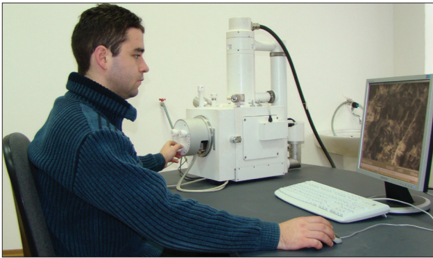
В лабораторії електронної мікроскопії кафедри технології підвищення зносостійкості досліджується наноструктура металу (збільшення в 300 000 разів)
