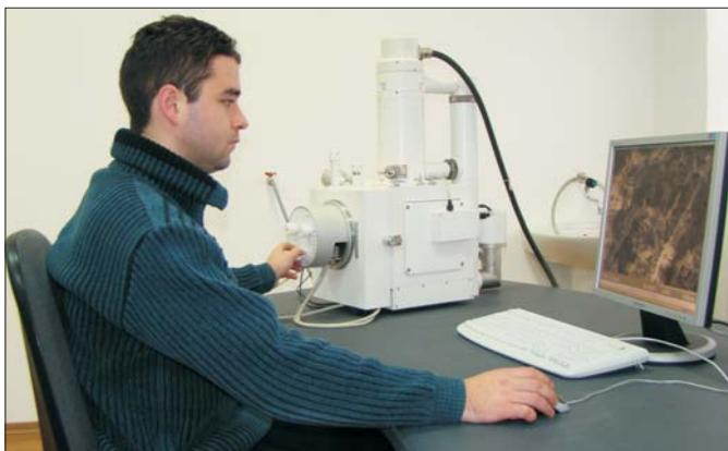
**Четвертоокурсник Вадим Коган досліджує наноструктуру металу на електронному мікроскопі (збільшення в 300 000 разів).**
