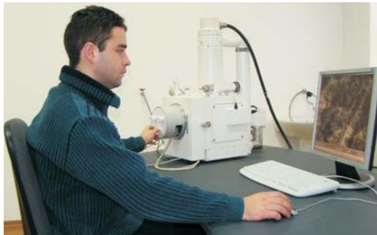
*Випускник Вадим Коган досліджує наноструктуру металу на електронному мікроскопі (збільшення в 300 000 разів). Навчальні та наукові комп'ютерні технології в ІНМТ впроваджені на усіх спеціальностях*
